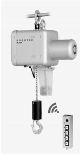
高精度荷重センサーと速度可変サーボシステムを組み合わせた電動バランス。制御に独自の慣性補償制御を組み込み、約1トンのつり荷でも数百グラムの力で荷に衝撃を与えることなく、荷の重量が変化しても瞬時にバランスする。またフックが外れた場合でも速度・加速度制限により危険な動作を制限。荷重分解能は定格荷重の1万分の1を確保し、高精度の制御が可能。2台を協調運転することで荷を傾げずに通常のバランス制御ができる。
