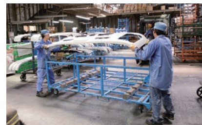
二人がかりでのバンパー詰め替え。品質維持の面と重量により、慎重さが求められる。
