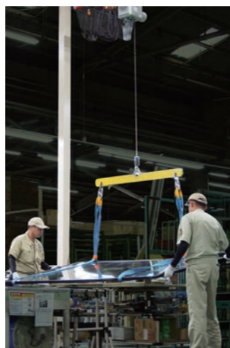
大型窓ガラスの反転作業をスリングベルトのみで行う
