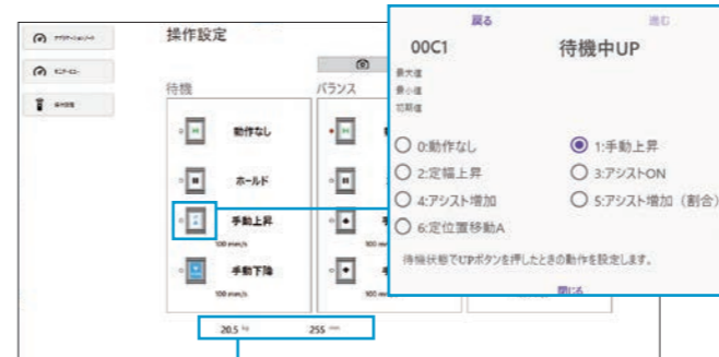
ワーク重量、チェーン繰出し量を表示
