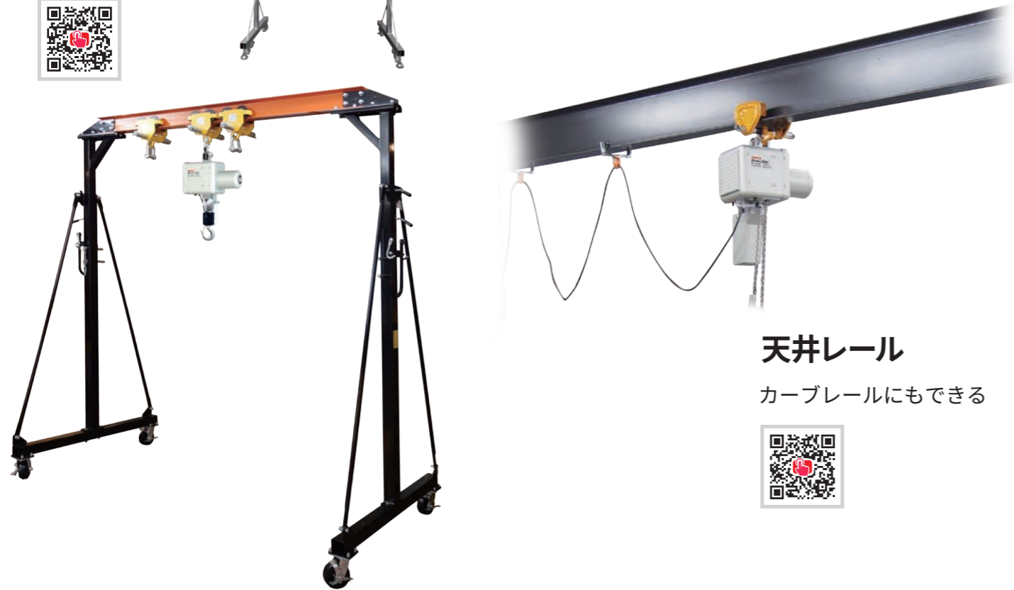
門型クレーン 高さの調整ができ移動も簡単 単管パイプタイプもあります
