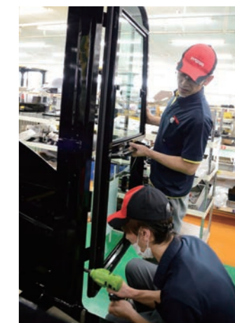
2人作業だったボルト締めが1人でも可能に
